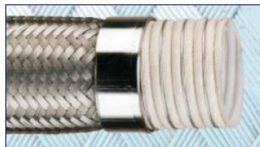
Tubo flessibile con sottostrato in PTFE corrugato e sinterizzato, con rinforzo in fibra di vetro ed una spirale in acciaio inox, copertura con una treccia in AISI 304.
