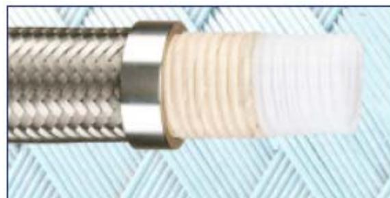
Tubo flessibile con sottostrato in PTFE corrugato e sinterizzato, con rinforzo in fibra di vetro, copertura con una treccia in AISI 304.
