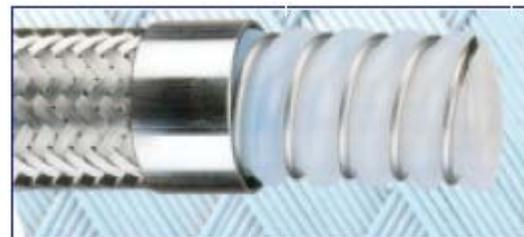
Tubo flessibile con sottostrato in PTFE convoluto elicoidale ad onda lunga estruso e sinterizzato senza giunzioni, con una spirale in acciaio inox ed una treccia in AISI 304. Adatto al settore alimentare, farmaceutico e chimica fine, in quanto l'onda lunga ne garantisce l'alta lavabilità, inoltre la spirale inox conferisce al tubo un'elevata flessibilità ed ottima resistenza al vuoto.
