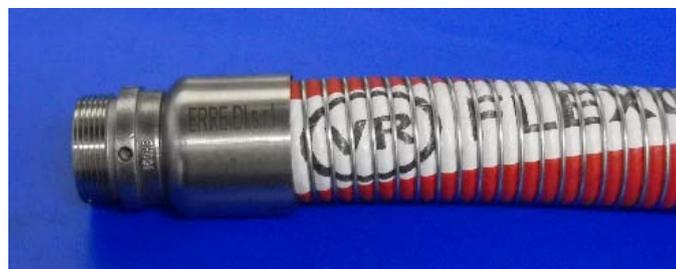
Il tubo composito FLEXCHEM-TXX, è costruito attorno a multistrati di Politetrafluoroetilene (PTFE), avvolti tra una spirale interna ed esterna in acciaio inox, inoltre nella costruzione viene inserito un tubolare in FEP. Tessuti di rinforzo ad alta resistenza completano la struttura. La copertura è costituita da tessuti in poliestere impregnati con speciali termoplastici resistenti all'abrasione, agli agenti atmosferici, la luce, i raggi UV e l'ozono.
