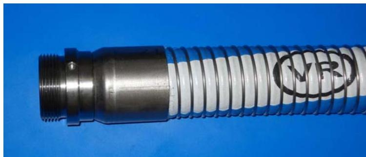
Il tubo composito FLEXCHEM-PPZ, è costruito da multistrati di film e tessuti in Polipropilene e Poliestere, avvolti tra una spirale interna in acciaio rivestita in Polipropilene ed una spirale esterna in acciaio zincato. La copertura è costituita da tessuti in poliestere impregnati con speciali termoplastici resistenti all'abrasione, agli agenti atmosferici, la luce, i raggi UV e l'ozono.
